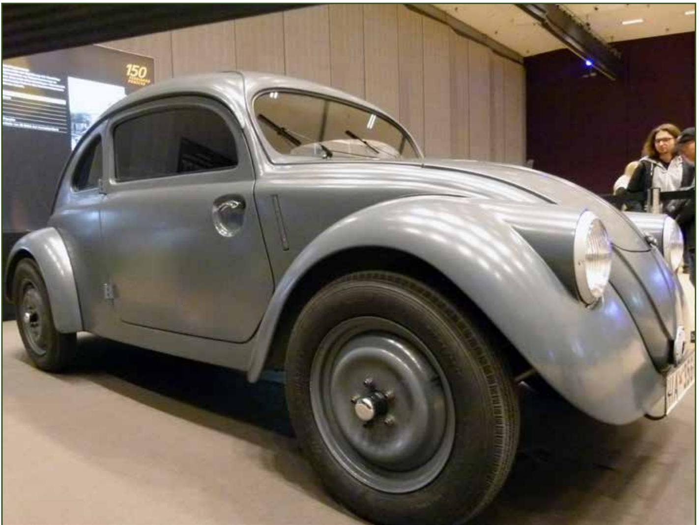
Die Türen öffneten nach hinten und es gab Winker zur Fahrtrichtungsanzeige
