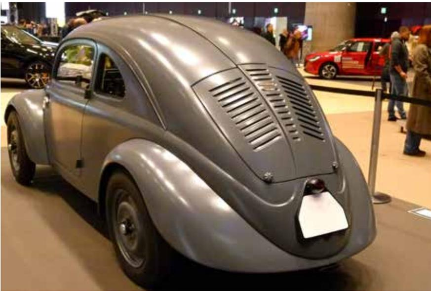
Das Heck war bereits stromlinienförmig aber noch ohne sichtbares Fenster. Dieses war stehend hinter den Rücksitzen angebracht und durch die Schlitze der Motorhaube konnte man nach hinten sehen.
